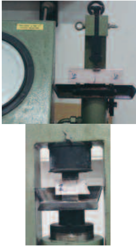
Resim 5. Laboratuvar ortamında yapılan eğilme ve basınç deneyleri
