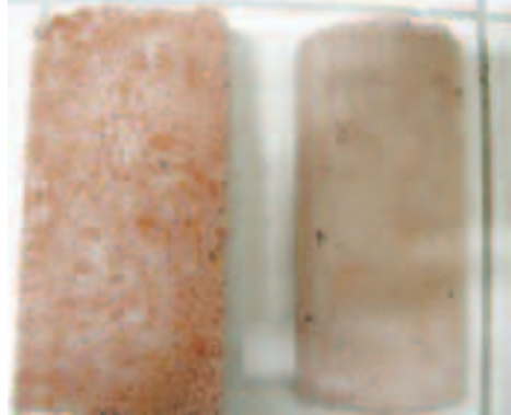
Resim 4. Laboratuvar ortamında hazırlanan horasan harçları
