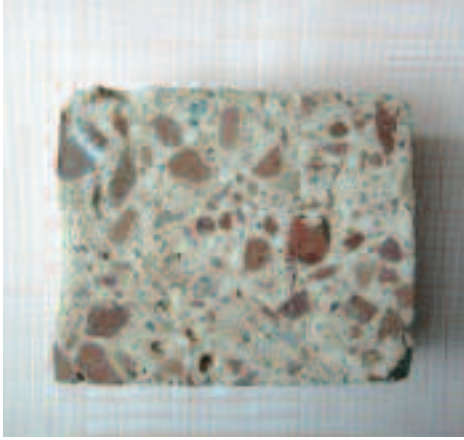
Resim 1. Magneura Sarayı'ndan alınan harç parçaları
